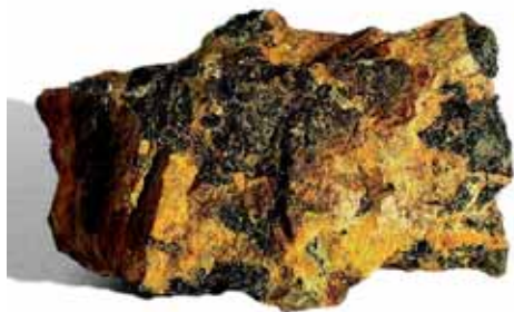
Fig.5 - Un campione di pechblenda, un minerale di uranio sempre impuro, di composizione UO_2 (foto tratta dal sito: www.minerva.unito.it ).
