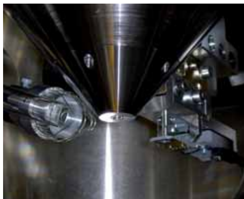
Fig.12 – Il "cuore" del SEM, l'obiettivo, da un detector e parte della camera portacampioni (foto: N. Angeli).
