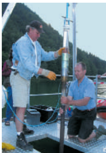
Fig. 6 a, b, c, d - Esempi di diverse piattaforme e carote: a - piccola piattaforma completamente smontabile e trasportabile a spalle per campionare laghi di alta quota; b - piattaforma della ditta austriaca UWITEC usata per campionare i laghi di Lavarone e Caldonazzo; c, d - carotiere a gravità UWITEC per carote corte (foto: N. Angeli e P. Oss Emmer).
