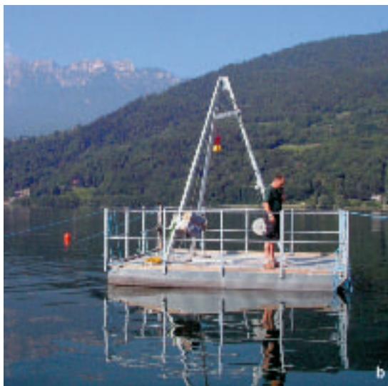
Fig. 6 a, b, c, d - Esempi di diverse piattaforme e carote: a - piccola piattaforma completamente smontabile e trasportabile a spalle per campionare laghi di alta quota; b - piattaforma della ditta austriaca UWITEC usata per campionare i laghi di Lavarone e Caldonazzo; c, d - carotiere a gravità UWITEC per carote corte (foto: N. Angeli e P. Oss Emmer).
