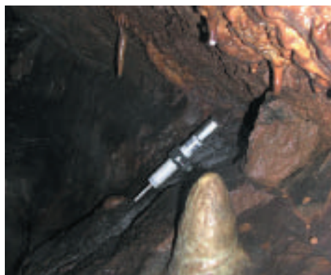
Fig. 19 - Uno dei datalogger di temperatura posizionati all'interno della grotta (foto: R. Miorandi).
