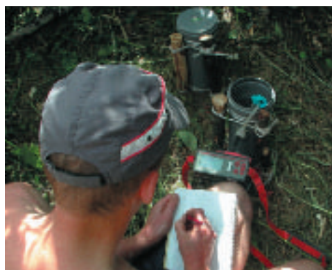
Fig. 20 - Tubi nel suolo per la misurazione di CO 2 (foto: M. Zandonati).
