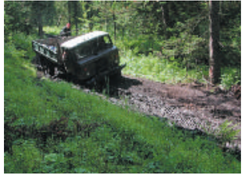
Fig. 16 - Camion utilizzato per il trasporto del legname. Questo è tra gli unici automezzi disponibili in grado di percorrere questi tracciati caratterizzati da profondi solchi (foto: M. Zandonati).
