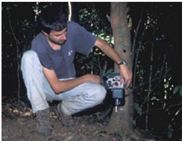
Figg. 12, 13, 14 – Le varie fasi di installazione di una fototrappola in natura: è evidente la necessità di proteggere la strumentazione dagli agenti atmosferici, come pure l'esigenza di eliminare eventuali ostacoli visivi tra la camera e l'are di scatto (foto: M. Menegon e F. Rovero).
