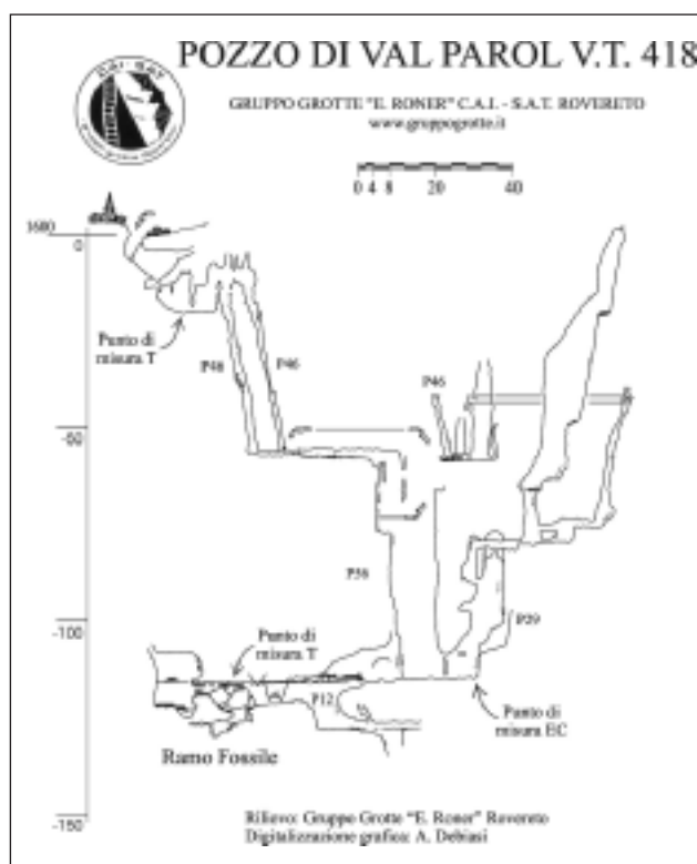
Fig. 5 - Sezione semplificata dei primi 150 m del Pozzo di Val Parol (rilievo: Gruppo Grotte Rovereto, 2001).
