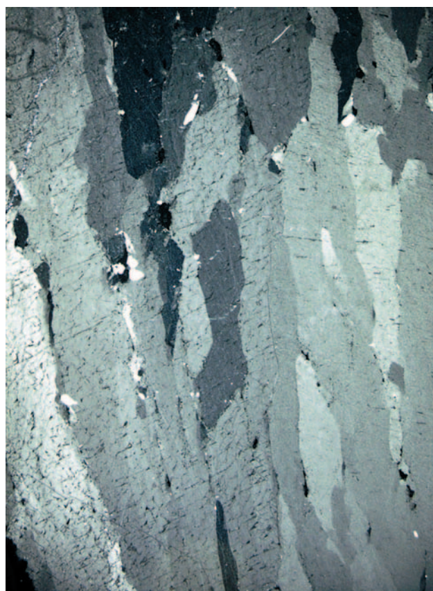
Fig. 6 - Sezione sottile a nicols paralleli dello speleotema GV3, presso la base del campione. Base della figura = 13 mm. Fig. 6 - Thin section (parallel nicols) of speleothem GV3, near the base of sample. Base of the figure = 13 mm.
