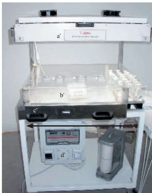
Fig. 1 - Foto della piastra a gradiente termico; a= serie di neon che possono essere abbassati o rialzati per ottenere l'intensità desiderata; b= lastra d'alluminio, c= elemento riscaldante, d= termostato e timer per le luci.
