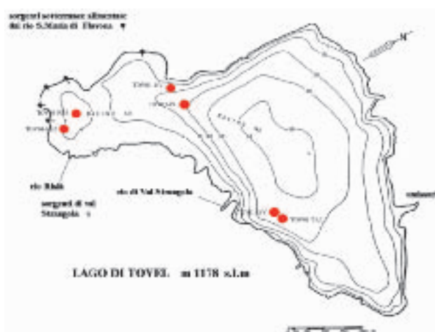
Fig. 1 - Lago di Tovel e localizzazione dei siti di prelievo delle carote datate tramite radionuclidi a vita breve, ^{210}\text{Pb} e ^{137}\text{Cs} .
