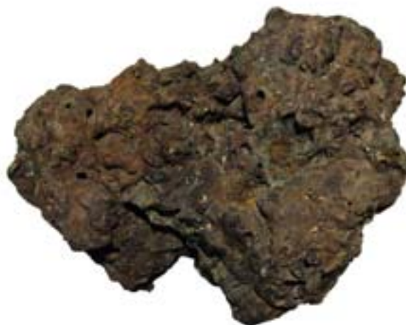
Fig. 2 - Scoria di fusione ( slacca ) proveniente dal sito di Val Restel (Vallarsa). Cm 26 x 20. Collezione Gruppo Grotte “E. Roner” Rovereto. Foto P. Ferretti.
