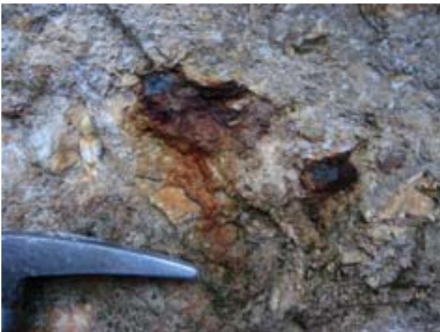
Fig. 10 - Noduli di marcasite alterata entro la base del Calcare di M. Spitz brecciato e metamorfosato per contatto presso l'ingresso della galleria di quota 980 m ( Alterstolln ) della Miniera di Val Gerlano. Foto P. Ferretti.
