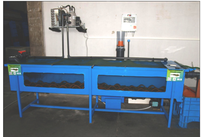
Fig. 2 - Impianto sperimentale a circuito chiuso per l'allevamento di scazzoni.
